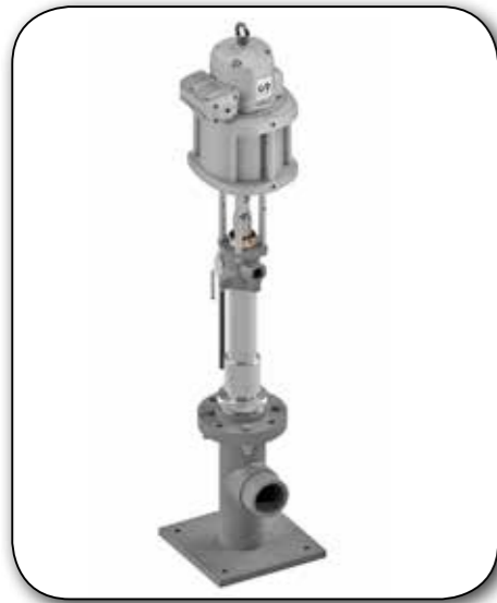
Dynamic-Primer-Pumpe PM80 mit Verhältnis 20:1 zum Extrudieren schwerer Materialien, Befestigung durch Montieren des Flansches am Bodenstativ der Saugeinheit
