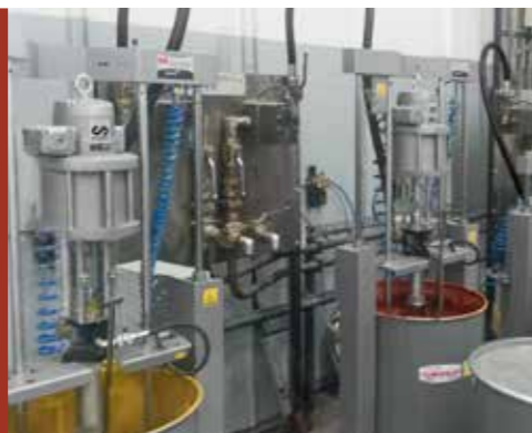
Dynamic-Primer-Pumpe PM35 mit Verhältnis 60:1, Schmiervorrichtung zum Auftragen schwerer Fette.
