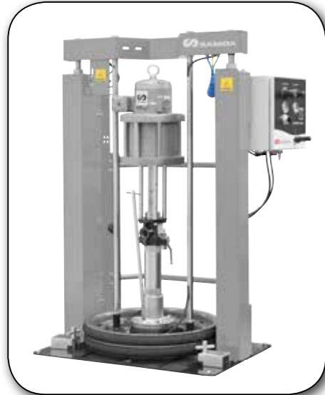
Dynamic-Primer-Pumpe PM80 mit Verhältnis 50:1 zum Extrudieren schwerer Materialien, Befestigung an einer druckluftbetriebenen Induktorplatte mit Doppelpfosten
